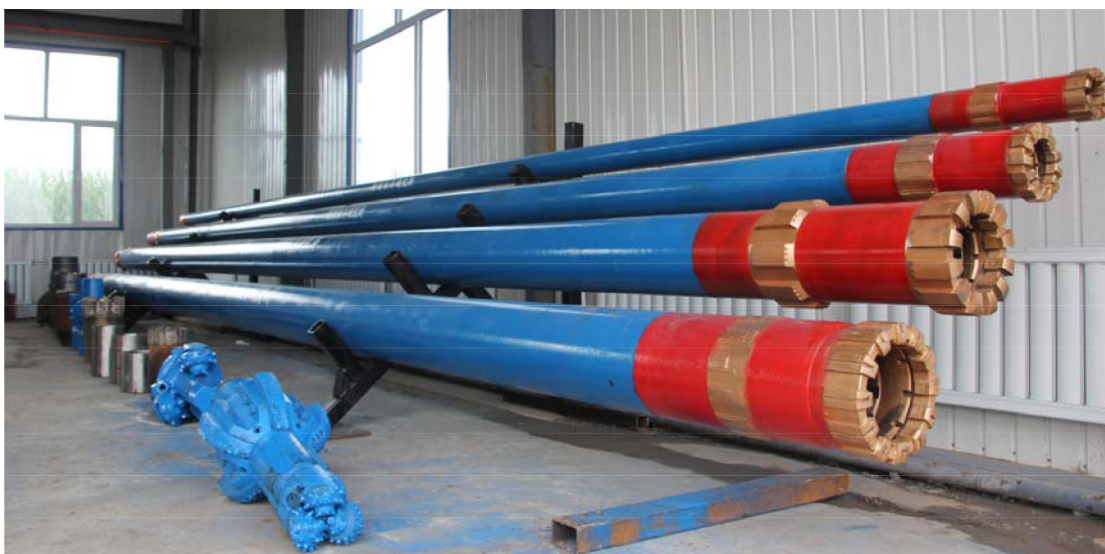
图2 KT系列大口径取芯钻具图
