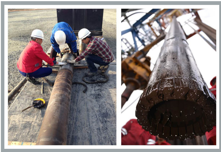
图3 \Phi 311\text{mm} 大直径取心 钻具组装与出井
