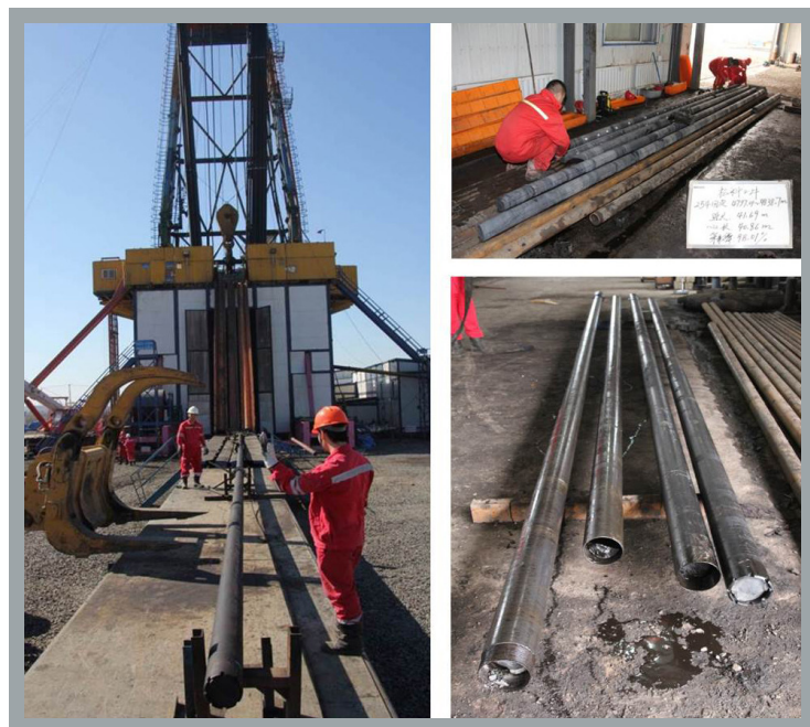
图4 四筒超长取心钻具与单次钻进获取的40m岩芯
